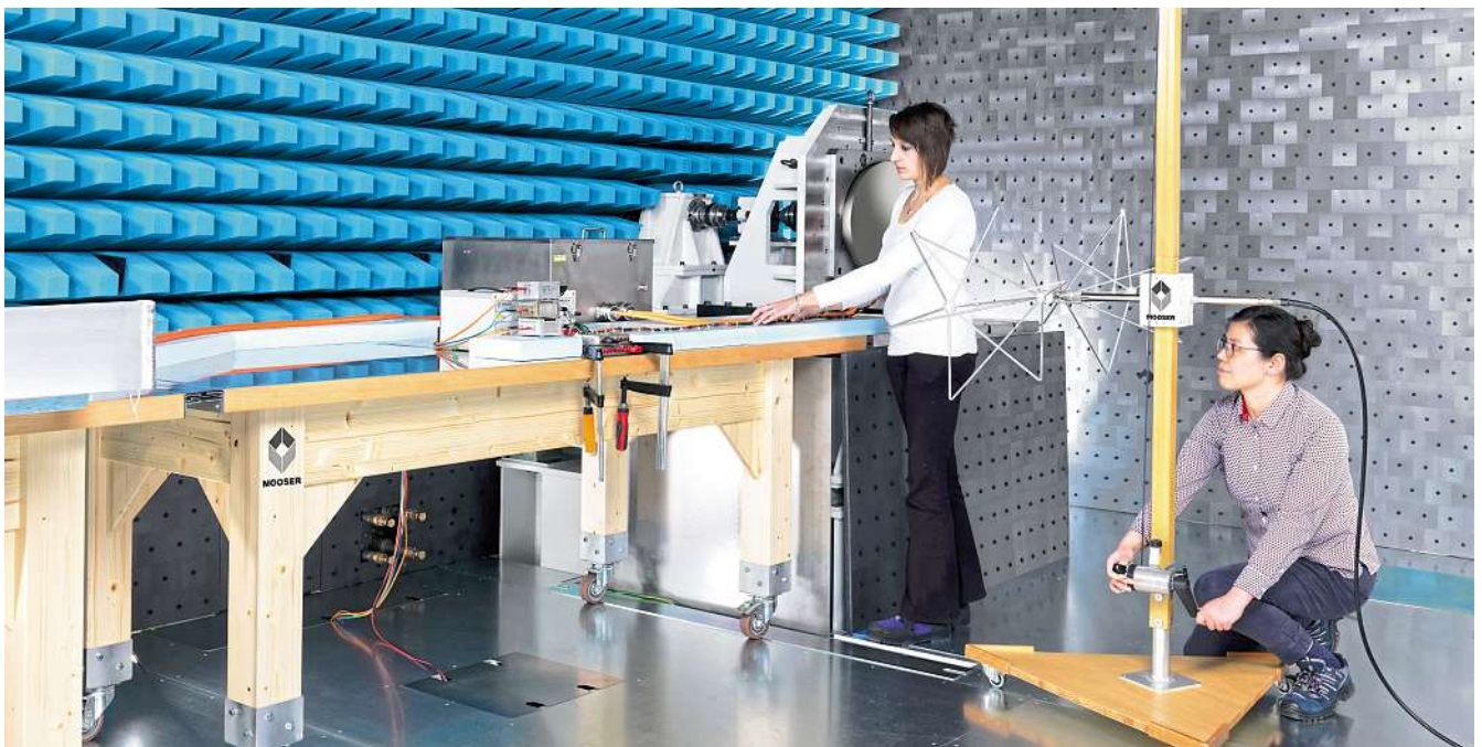
Die E-Chamber ist speziell für Hochvolt-Elektroantriebe und elektrisch angetriebene Nebenaggregate ausgelegt.
